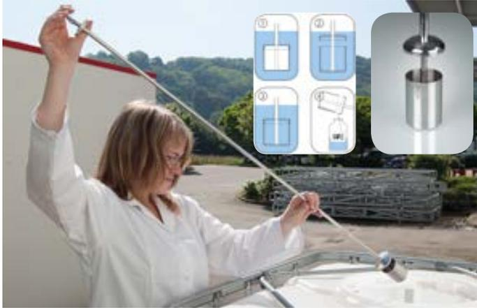
El muestreador Liquid CupSampler, fabricado en acero inoxidable V4A, permite tomar muestras dirigidas de líquidos de diferente viscosidad. También se puede emplear correctamente para medios que contienen partículas.
