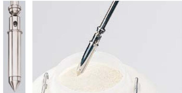
A la hora de realizar el análisis de materiales en polvo altamente potentes, caros o activos, se recogen solamente cantidades muy pequeñas. Con el Pharma-picker se pueden tomar muestras en cantidades mínimas que oscilan entre los 0,1 ml y los 2,5 ml. Mediante un sencillo cambio de las puntas en los cilindros de recogida para 0,1 - 1,2 ml o 1,25 - 2,5 ml se modifica el volumen de la muestra.
