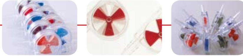
Indicadores de caudal para la visualización óptica precisa de la velocidad de flujo de líquidos y gases que se transportan a través de mangueras. El indicador de caudal con rueda de palas funciona en ambas direcciones de flujo y en cualquier posición de montaje. La rueda de palas gira a partir de unos 150 ml/min (líquidos).
