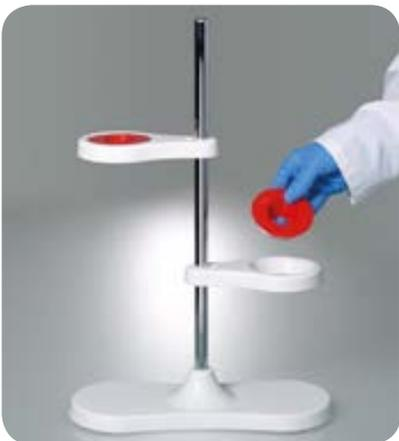
Soporte para embudos con dos fijaciones de embudo y dos insertos reductores. Diseño con reducidas dimensiones, con dos superficies prácticas de apoyo.
