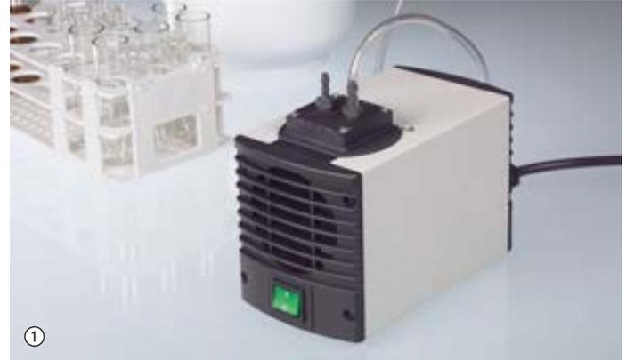
La bomba de vacío de membrana con un cabezal AirJet Mini resulta ideal para numerosas aplicaciones tanto de laboratorio como industriales. Esta bomba de marcha en seco trasiega, comprime y evacúa totalmente sin aceite, suprimiendo la contaminación y el ensuciamiento, y también puede utilizarse como compresor. La AirJet Mini permite trasegar y evacuar tanto aire como gases y vapores neutros o ligeramente agresivos o corrosivos.
