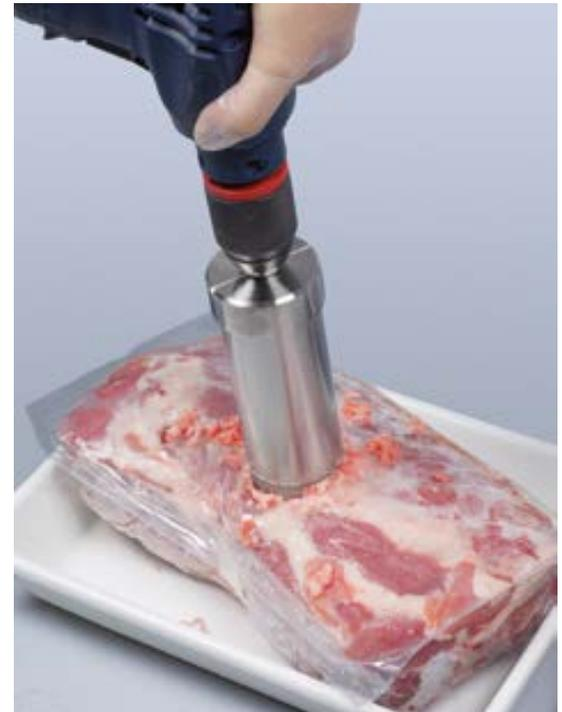
Muestreador para productos congelados del sector de los productos alimenticios y de degustación, así como para sustancias semisólidas y hielo. La broca hueca de gran solidez corta rápidamente el producto de muestreo mediante su corona de serrado. Se puede cortar un cilindro de muestreo (muestra transversal) con una longitud de hasta 20 cm.
