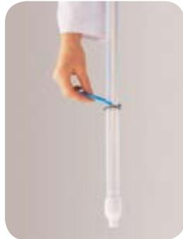
ViscoSampler, muestreador con alto poder de succión para medios altamente viscosos. El medio se succiona con el émbolo aspirante y después, se expulsa. Está fabricado en PTFE/FEP ultrapuro y químicamente inerte para un muestreo libre de contaminación.
