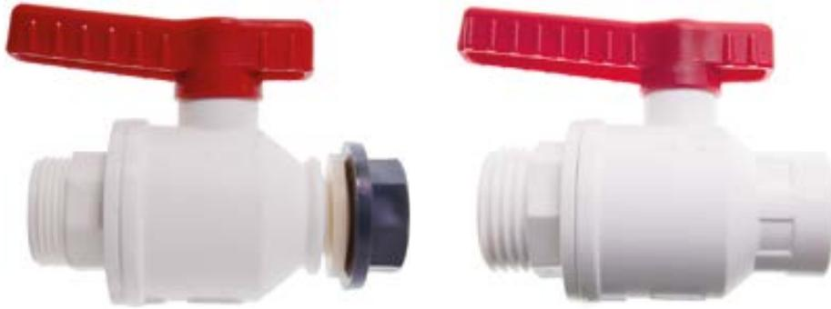
Grifo de rótula fabricado en PP con rosca exterior/interior, reforzado con fibra de vidrio, rótula de PP, mango con junta tórica de NBR inalterable por comestibles y junta de HDPE.
