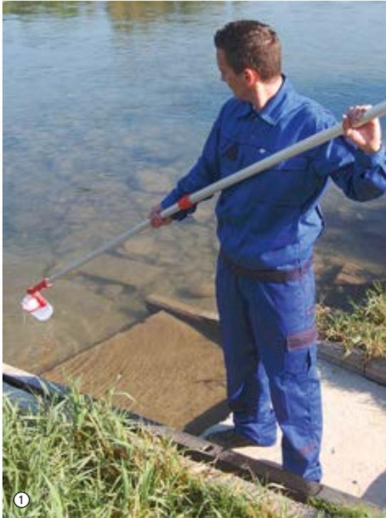
TeleScoop es un variado sistema de muestreo con herramientas intercambiables para las aplicaciones más diversas. Las herramientas (vasos angulares, vasos pendulares, portabotellas, vasos de acero inoxidable y redes) se acoplan a la pértiga telescópica con una práctica conexión rápida.
