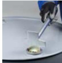
Llave universal para barril, para una fácil apertura de abrazaderas de rosca fijas de 3/4" a 2". Una herramienta indestructible fabricada en acero galvanizado.
