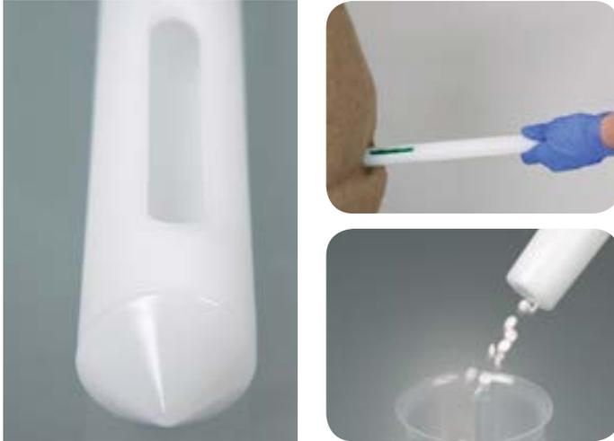
El TargetDispo permite coger una muestra en un punto específico del material previamente determinado. El colector penetra cerrado en el polvo en el granulado, y solo cuando se ha llegado al punto de extracción, se abre y se vuelve a cerrar. De esta manera, se toma una muestra exactamente del punto deseado. La muestra se puede vaciar fácilmente por la empuñadura abierta.
