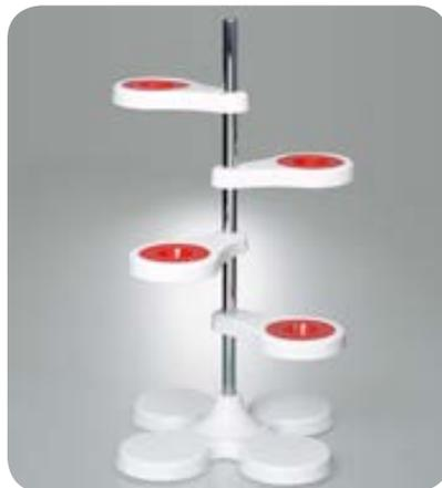
Soporte para embudos con cuatro fijaciones de embudo y cuatro insertos reductores. Un pie de soporte muy estable ofrece superficie de apoyo para cuatro recipientes y asegura estabilidad absoluta.
