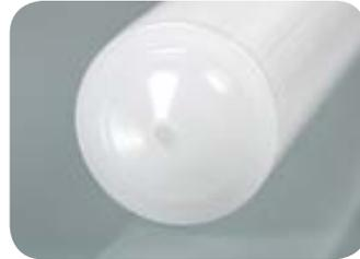
Los tomamuestras desechables LiquiDispo permiten coger muestras de líquidos muy fluidos hasta ligeramente viscosos. Una empuñadura ergonómica facilita la extracción de la muestra, permitiendo succionar hasta 200 ml igual que con una jeringuilla.
