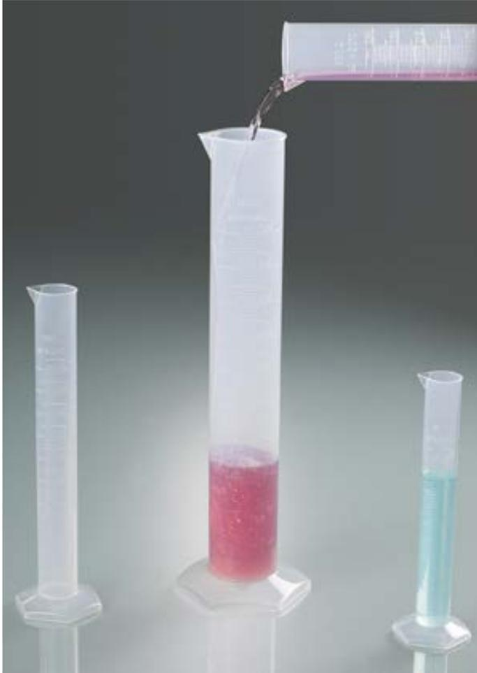
Probetas en formato alto, conforme a DIN 12 680 (cristal)/ISO 6706, con base hexagonal. Para el uso en laboratorios, farmacias, en talleres, en pruebas al aire libre y, en general, allí donde se tengan que realizar procesos con mediciones de volumen.
