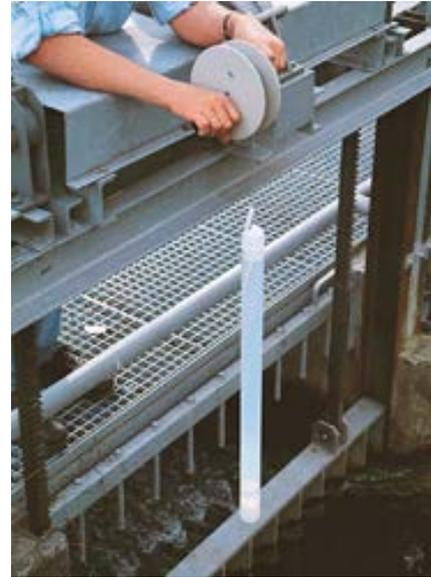
Apropiado para recoger muestras de aguas subterráneas de pozos, fosos y otras fuentes. Sus dimensiones le permiten introducirse en aberturas de hasta 2" de diámetro sin engancharse ni quedar atascado. La gran pureza del material garantiza un muestreo de la mayor pureza posible. Su forma sin bordes redondeados ni roscas facilita la limpieza.
