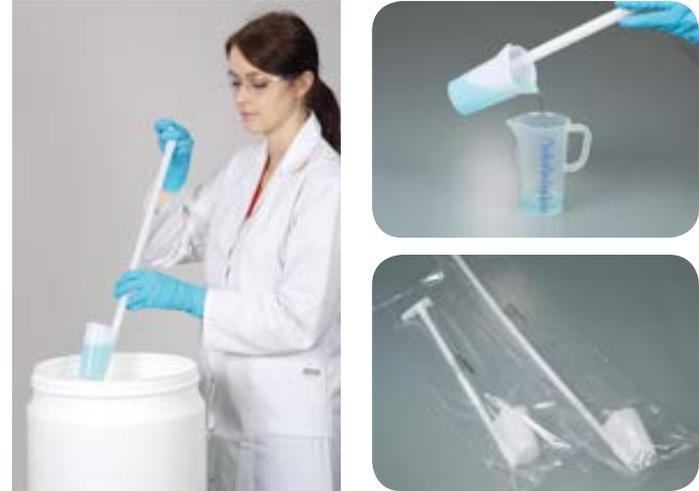
DispoLadle es un muestreador cucharón especialmente para el uso único. El vaso con escala y marca en relieve permite una medición e indicación de volumen en pasos de 10 ml, hasta 200 ml. La empuñadura ergonómica y la maniobrabilidad con mano derecha e izquierda con salidas en ambos lados facilitan y simplifican su uso.
