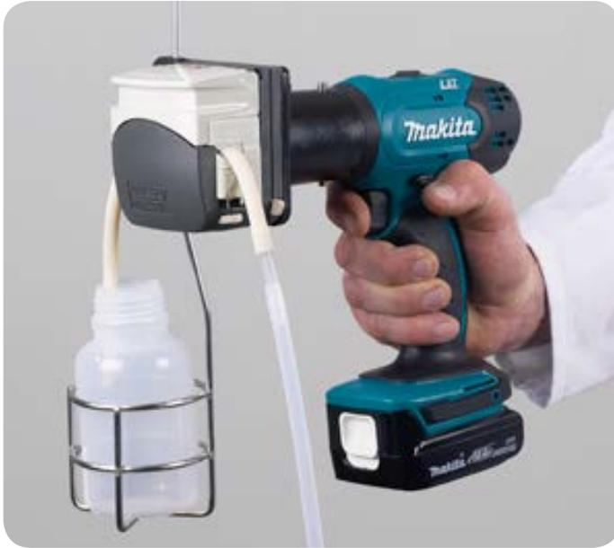
Fácil de transportar. Bomba para líquidos con funcionamiento por batería. Ideal para muestreos en barriles, depósitos, pozos, acequias y sistemas de depuración de aguas residuales. El Vampir se entrega en un práctico maletín para transporte que incluye: unidad motora, dos baterías, cargador, lámpara LED, cesta para botella muestra, botella de LDPE de 250 ml, bomba de manguera y 5 m de manguera de PE.
