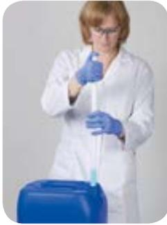
La elección del dispositivo adecuado para la toma de muestras está sujeta a criterios de elección muy distintos. Depende tanto de la calidad del material del muestreador como del tipo de muestreo, del recipiente o del lugar en el que se encuentra el material y de la frecuencia con la que se deben tomar las muestras aleatorias. Además de las exigencias individuales para la toma de muestras, cada muestreador debería cumplir las siguientes condiciones previas básicas:
