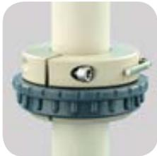
Racor de recipiente para la fijación de la bomba para barril en cualquier lugar de la pared del recipiente o en tapones de rosca de cuello ancho. El racor de 2" se fija desde el interior con una contratuerca de 2". (Perforación de montaje en el recipiente de 60 mm).
