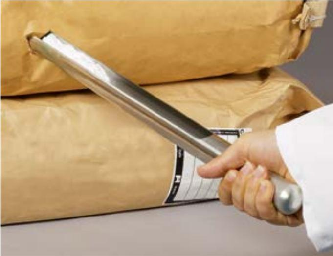
Colector universal para polvo y granulado fabricado en acero inoxidable V4A. Concebido originalmente para muestras de leche en polvo conforme a los estándares DIN y FIL (Federación internacional de lechería). El recolector se introduce perforando los sacos o toneles y se obtiene la muestra mediante la lanza en forma de semicubeta.
