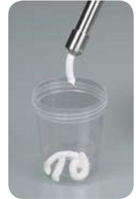
Colector de muestras para sustancias viscosas como pastas, lodos, cremas, aceites. La muestra se toma gracias a la succión del émbolo de la bomba y se deposita directamente en el recipiente para muestras. Es de fácil limpieza, lo que permite un muestreo excelente. Dependiendo de la viscosidad, el cabezal de succión (con rosca) puede sustituirse por otros cabezales con diámetro entre 2 y 6 mm.
