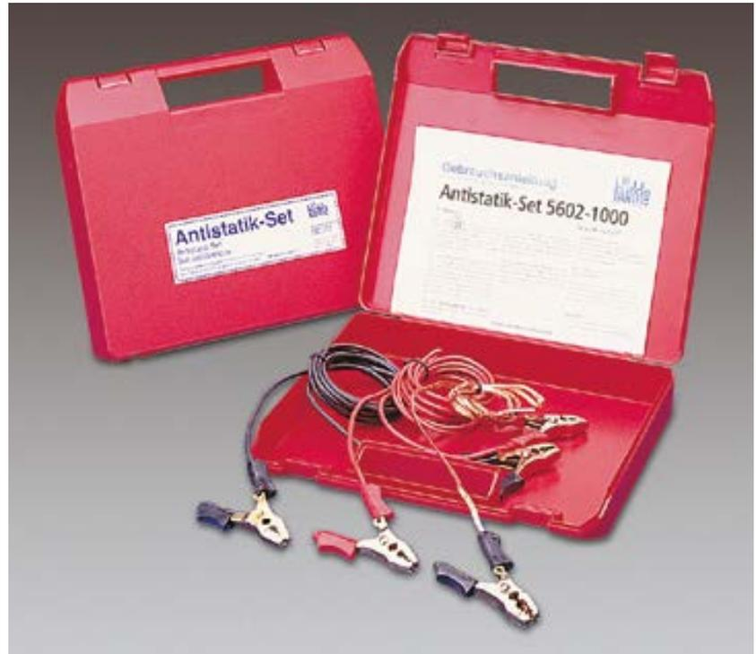
En el trasiego de líquidos inflamables, si se presenta alguna deficiencia en la conexión a tierra entre los aparatos y los recipientes, pueden producirse descargas electrostáticas que pueden provocar la combustión o la explosión de muchas sustancias. Con el kit antiestático de Bürkle se asegura una conexión a tierra sencilla y fiable. El kit antiestático se compone de tres cables coloridos de cobre con pinzas, presentados en un práctico maletín de transporte fabricado en material sintético.
