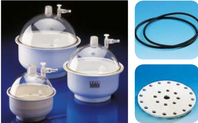
Desecadores de material plástico, irrompibles, ligeros y aptos para vacío. La llave es adecuada para un vacío de hasta 980 mbar. Parte inferior y pieza insertada agujereada fabricadas en polipropileno. Tapa de policarbonato transparente con válvulas de retención y ventilación. Sellado con junta tórica de caucho de policlorobutadieno. Temperatura constante máx. + 60°C.
