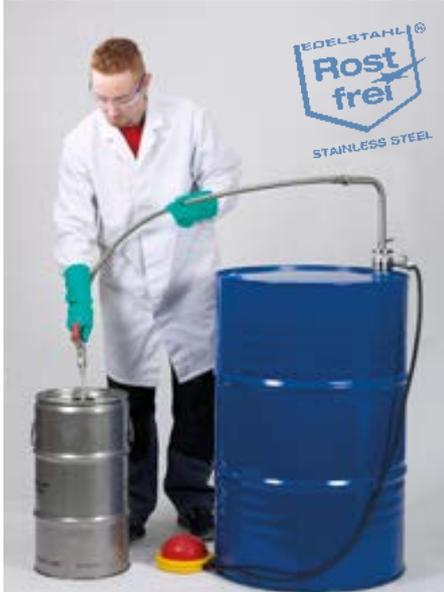
Bomba para disolventes con accionamiento de pedal para el trasiego de líquidos de gran pureza como p. ej. disolventes.
