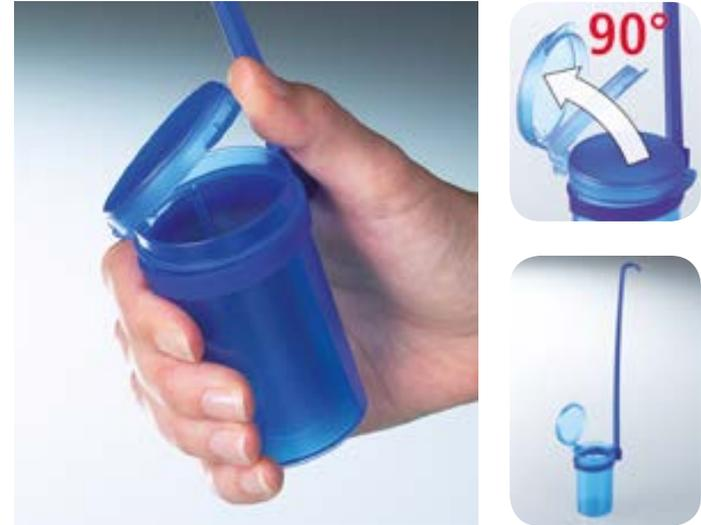
Frasco cuchara estéril con mango desmontable y tapa de cierre hermética. La tapa se puede abrir con una mano y se orienta en un ángulo de 90°. El líquido/condensado de la tapa se conduce a una acanaladura colectora integrada en la tapa, por lo que nada se pierde ni gotea.
