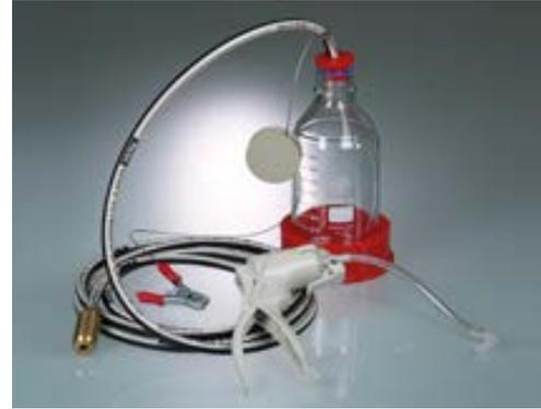
Muestreador desarrollado especialmente para el muestreo de líquidos inflamables de la clase de peligro AI (VbF, p. ej. gasolina). La botella de cristal y la manguera están conectadas de tal manera que pueden conducir la electricidad y por ese motivo se deben conectar a una toma de tierra.
