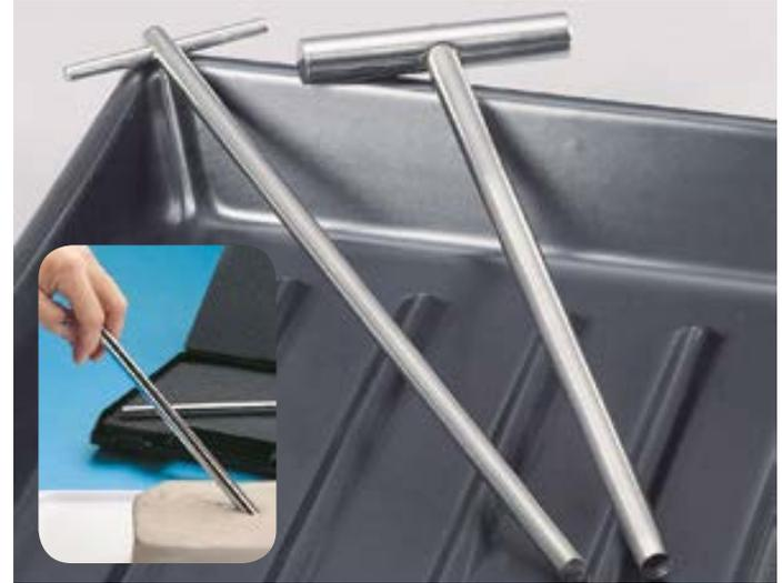
Muestreador cilíndrico hueco con bordes cortantes. El muestreador entra fácilmente en las sustancias pastosas con un movimiento rotativo. Las muestras que han sido cortadas se retiran posteriormente del muestreador mediante el mecanismo expulsor que se encuentra en el mango. Longitud total 260 mm. Diámetro interior 8 mm, diámetro exterior 10 mm.
