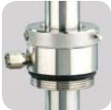
La abrazadera de rosca estanca al gas evita la salida del barril de gases peligrosos para la salud. Rosca de acero R2", válvula de retención con conexión 1/8". Latón niquelado, juntas de FKM.
