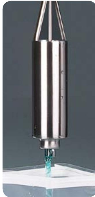
La válvula se abre con el pulgar para vaciar la muestra.
