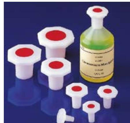
Tapones fabricados en PE, huecos con anillos de obturación y mango octogonal.
