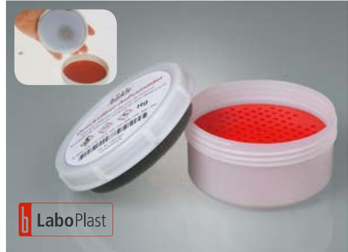
El recogedor de mercurio de Bürkle permite recoger de forma sencilla el mercurio derramado y volver a utilizarlo. El recogedor está compuesto por un recipiente con una tapa de rosca a la que se le ha colocado una capa de espuma plástica especial. Si se presiona suavemente sobre el mercurio derramado, los poros de la espuma se abren y recogen las gotas de mercurio. Cuando la tapa se enrosca al recipiente, las gotas se sueltan y caen dentro a través del disco separador perforado.
