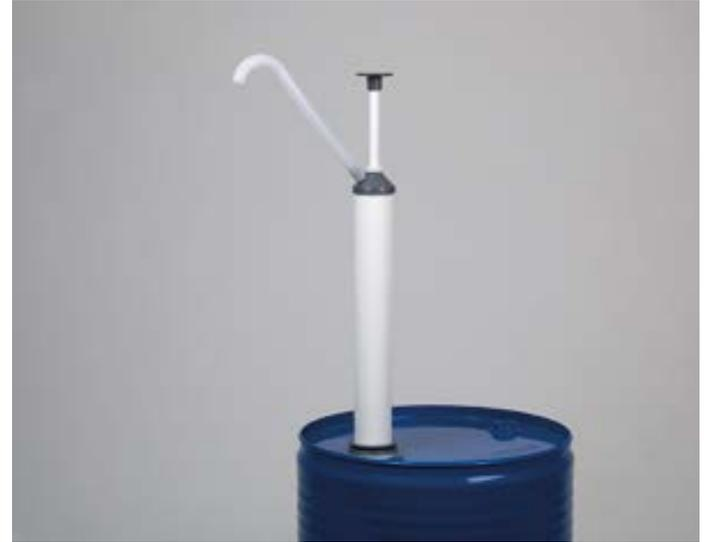
La bomba de émbolo para líquidos y productos petroquímicos está fabricada en polipropileno y polietileno. Ofrece una buena relación precio-rendimiento. La bomba de émbolo se fija al recipiente de origen por medio de una rosca de barril de 2" o 3/4". Además, una vez realizado el montaje, la bomba se puede girar sobre su eje, de modo que también se pueden colocar recipientes de llenado sobre la tapa del barril.
