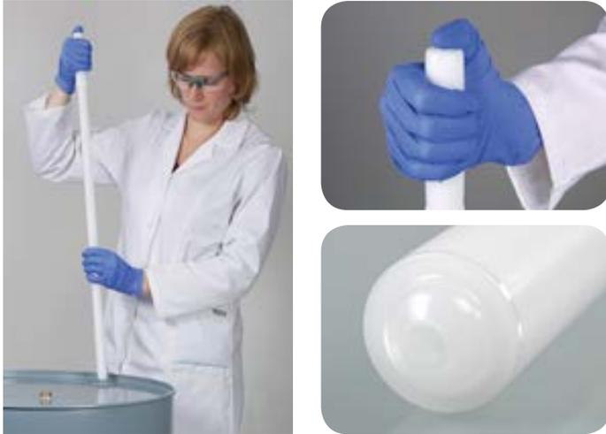
La empuñadura ergonómica del DispoTube facilita el trabajo y posibilita un buen agarre incluso bajo condiciones adversas como por ejemplo al llevar guantes. Colector de muestras desechable para coger muestras de líquidos.
