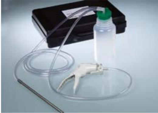
UniSampler con manguera de PVC y pesa de acero inoxidable. Para lugares profundos o en ángulo. El tubo flexible se arrastra hasta el fondo mediante un tubo metálico pesado.
