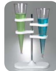
El soporte para el embudo de sedimentación sirve para la conservación, fijación y el almacenamiento seguro y práctico de embudos Imhoff durante la sedimentación.
