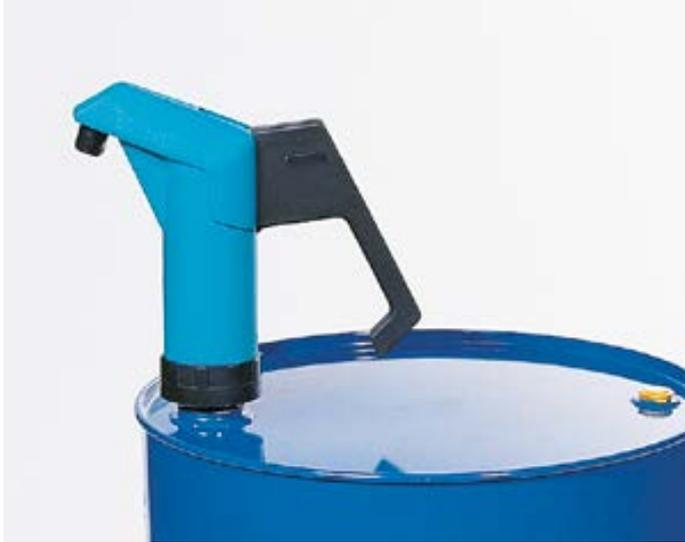
Bomba de palanca autoaspirante compacta de polietileno, apta para líquidos alcalinos y multitud de ácidos. El tubo de aspiración telescópico de la bomba de palanca puede salir de manera gradual hasta un máximo de 914 mm, gracias a lo que puede utilizarse con barriles de 60 a 200 l.
