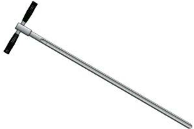
Recogedor de muestras Pürckhauer de gran solidez para suelos pesados y pedregosos. La punta cónica mayor de 60 cm del modelo 5350-5018 facilita considerablemente la extracción final del recogedor. Ideal también para la toma de muestras N-min de 0 a 90 cm.
