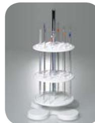
Soporte para pipetas con dos placas perforadas giratorias y bandeja colectora.
