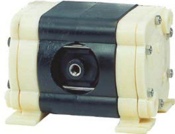
Bomba neumática de doble membrana para la circulación de líquidos viscosos, corrosivos, abrasivos e inflamables. Acabado de bomba 1/4". La bomba está disponible en polipropileno, PVDF y nailon. Las membranas, esferas y asientos se suministran en Geolast, PTFE y Santoprene. Se pueden transportar partículas sólidas con un diámetro de hasta 1,6 mm.
