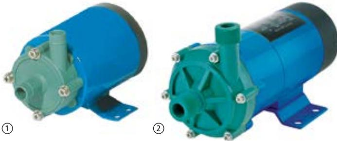
Las bombas centrífugas magnéticas son adecuadas para el transporte de ácidos, lejías, baños alcalinos y galvánicos, productos fotoquímicos y sustancias radioactivas, estériles y altamente corrosivas. Gracias al accionamiento a través de la transmisión de fuerza magnética sin contacto no son necesarias las obturaciones dinámicas de ejes, por lo que la carcasa de la bomba se encuentra sellada herméticamente y no permite ninguna fuga.
