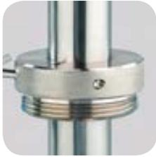
Abrazadera de rosca de latón niquelado para las bombas de acero inoxidable para barril. Evita la carga electrostática en combinación con el kit antiestático. Para el trasiego seguro de líquidos altamente inflamables. Para recipientes con rosca fina de acero R2" interior.
