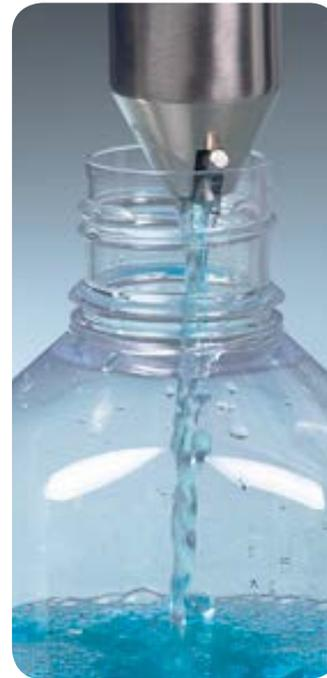
Para vaciar la muestra, la válvula se abre mediante su montaje en el recipiente de muestreo.
